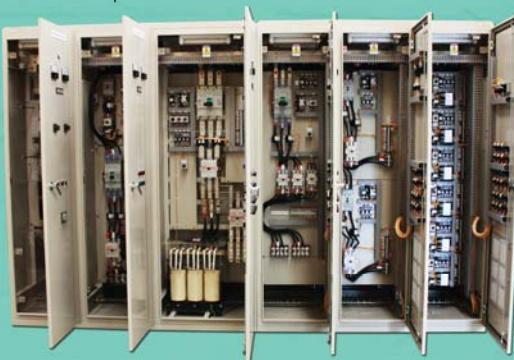
4. แผงควบคุมมอเตอร์ไฟฟ้า (Motor Control Center) หรือ MCC เป็นตู้ควบคุมมอเตอร์ไฟฟ้าที่เป็นตู้ที่ประกอบด้วยอุปกรณ์ควบคุมมอเตอร์ไฟฟ้า เช่น แมคเนติกส์คอนแทคเตอร์, โอลเวอร์โหลดรีเลีย, สวิทช์ปุ่มกด และ Pilot Lamp หรือ เซอร์กิตเบรคเกอร์ รวมทั้งสายต่อวงจรย่อย
