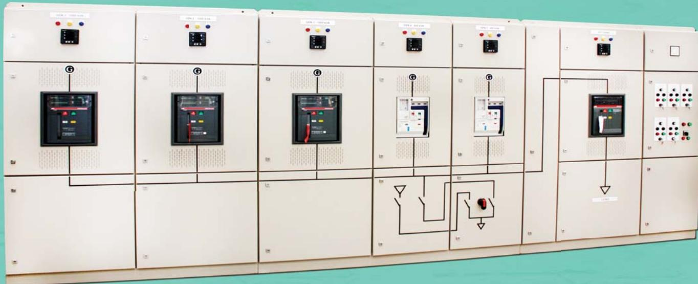
ตู้ MDBI เป็นตู้สำหรับจ่ายกระแสไฟฟ้าภายในอาคาร ซึ่งแต่ละตู้สามารถนำมาประกอบต่อ กัน เป็นตู้ขนาดใหญ่ได้ตามความต้องการ ตัวตู้มีความแข็งแรงด้วยโครงสร้าง และฐานตู้ที่ผลิตจากเหล็กแผ่นที่มีความหนา 3.0 มิลลิเมตร ซึ่งทำให้โครงสร้างที่เป็นอิสระของตู้แต่ละใบ สามารถรองรับน้ำหนักของบัสบาร์และอุปกรณ์ไฟฟ้าที่มีน้ำหนักมากได้ สะดวกในการขนย้าย เพราะสามารถถอดแยกตัวตู้ออกเป็นตอนๆ ได้
